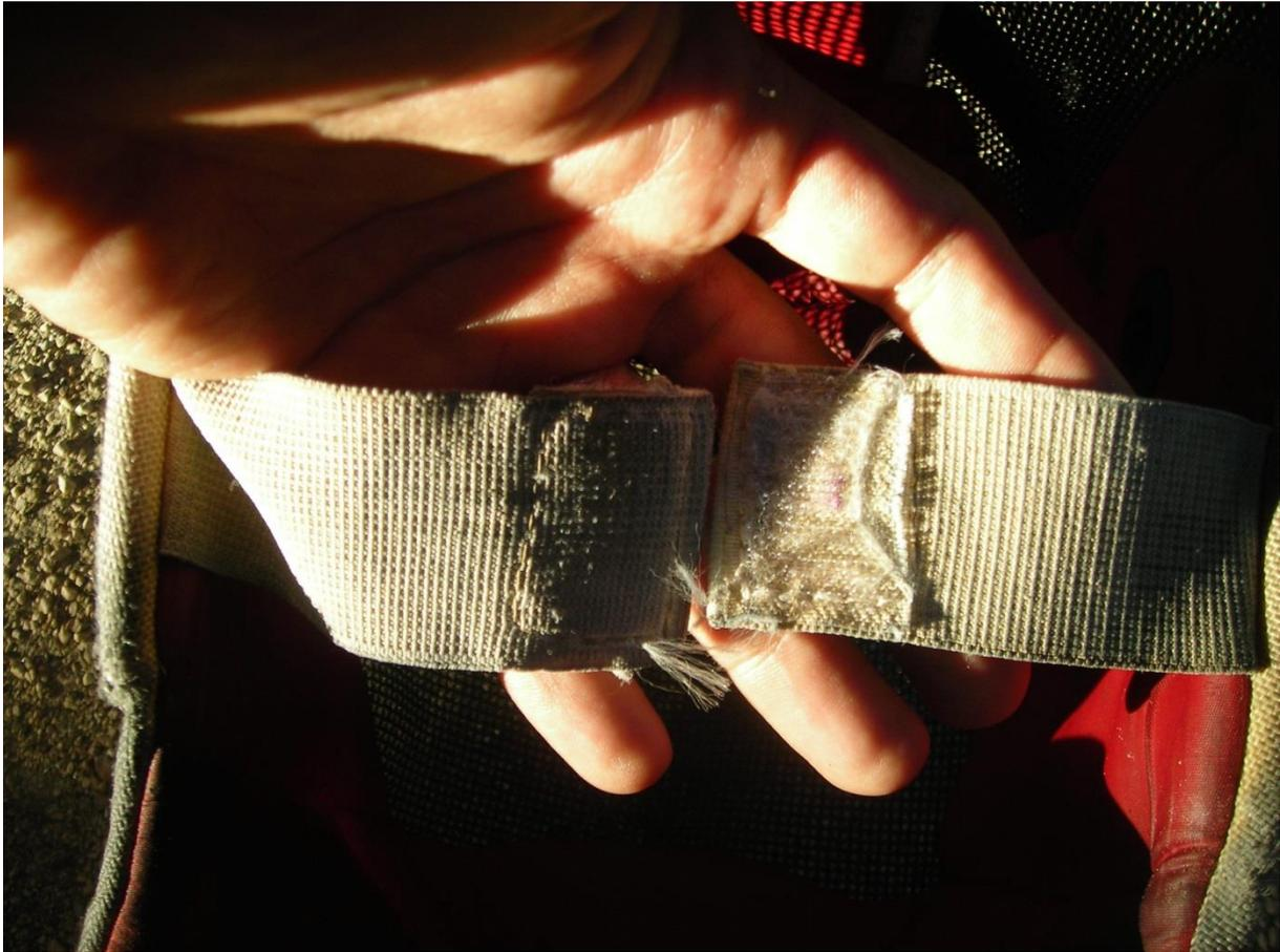
**Figure 5** : exemple de sangle trop abimé. Le scratch sur cette sangle ne tient plus tout seul, ce qui présente un risque conséquent d'arrachage de masque.
