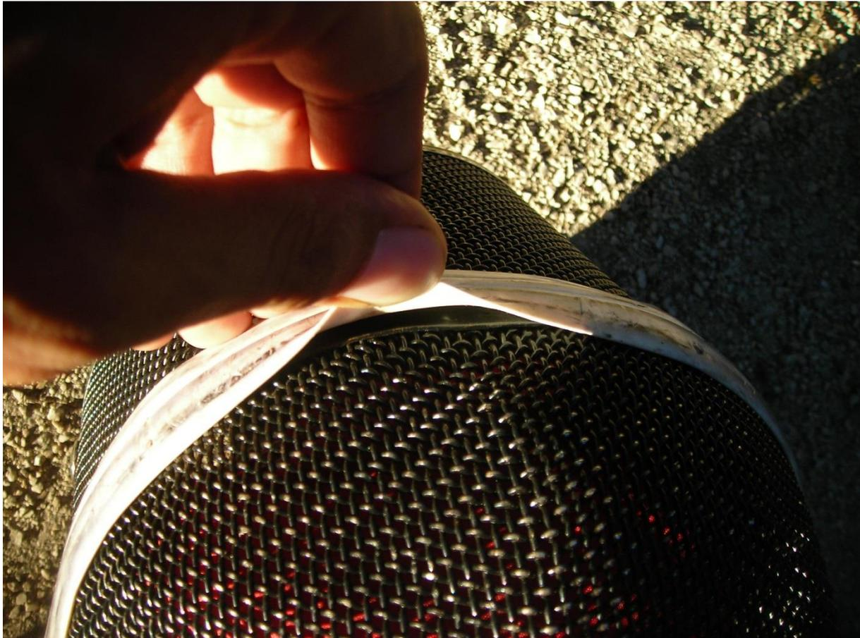
**Figure 2** : vérification de la soudure du grillage au cadre et de l'absence de rouille. Ici, l'impact au sommet du grillage est mineur : le grillage est toujours bien soudé au cadre. Il y a quelques petites traces de rouille, elles aussi mineures.
