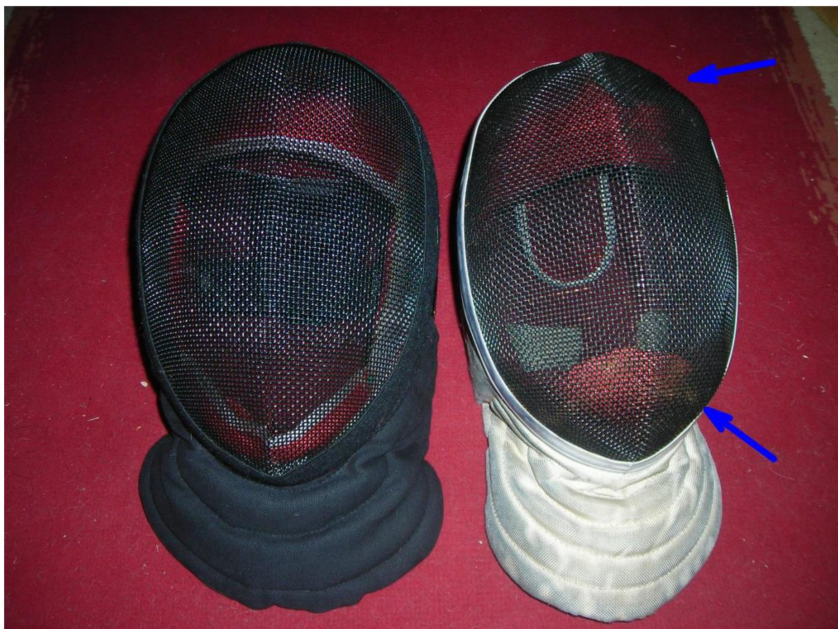
**Figure 1** : exemple de grillage en bon état à gauche. A droite, un masque présentant quelques impacts (flèche du haut) et des traces de rouille (flèche du bas), tous deux fragilisant.
