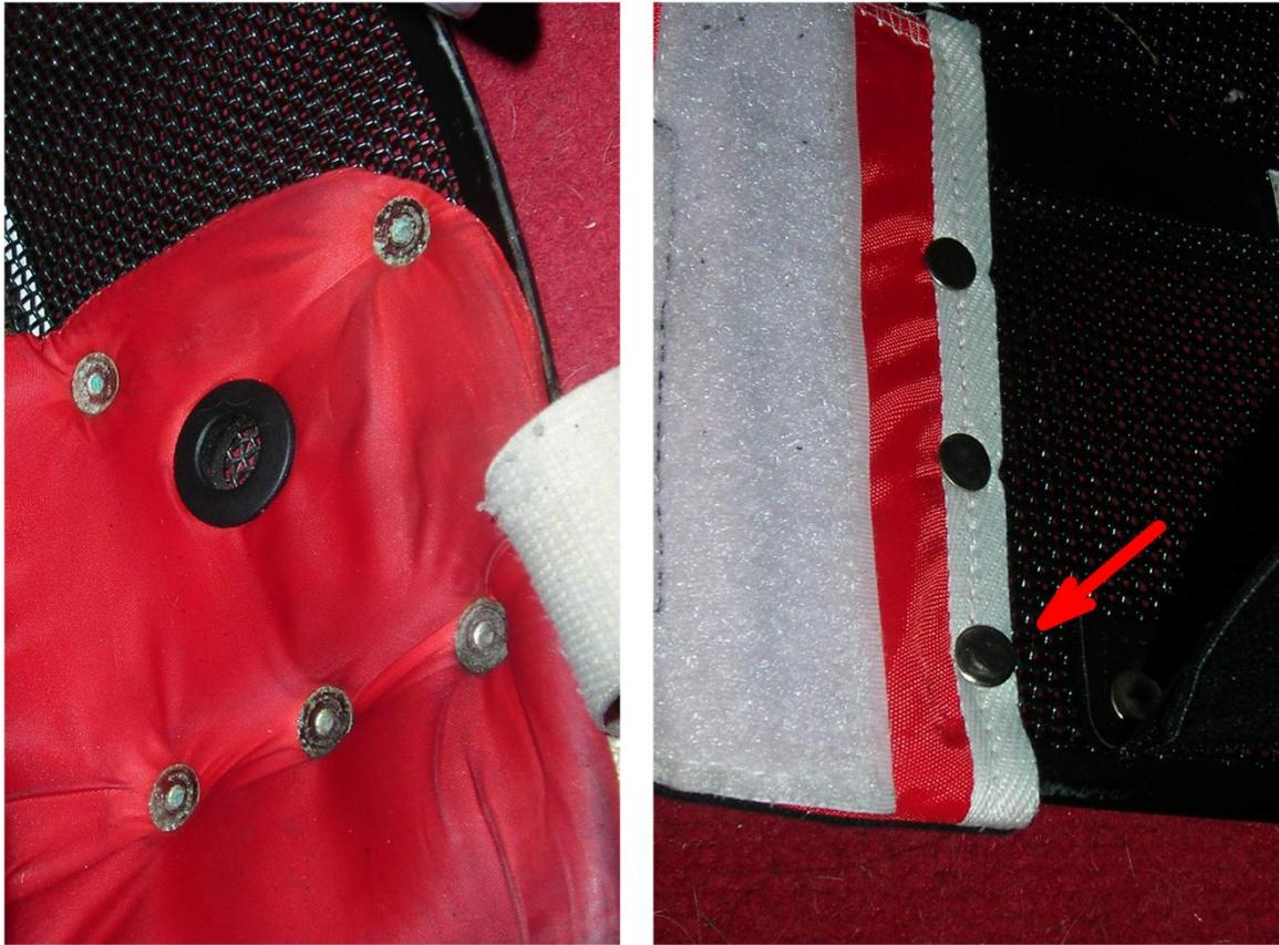
**Figure 4** : sur le masque de gauche, les rivets sont oxydés (taches blanches/verdâtres), mais éloignés de toute bordure de garniture. Sur le masque de droite, les rivets ne sont pas oxydés, mais l'un d'entre eux (flèche rouge) est un peu proche du bord.
