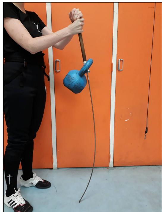
Flèche marquée de la lame : la flexibilité de l'épée est inférieure au seuil
